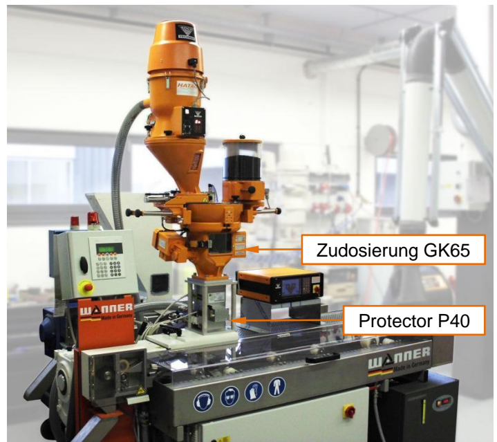
Thermogranulator als z.B. Compound-Anlage mit gravimetrischer Zudosierung GK65 von Koch-Technik und Protector P40 Metallsuche von Sesotec
