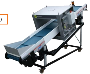
GL-Föba mit Metall-Detektion
