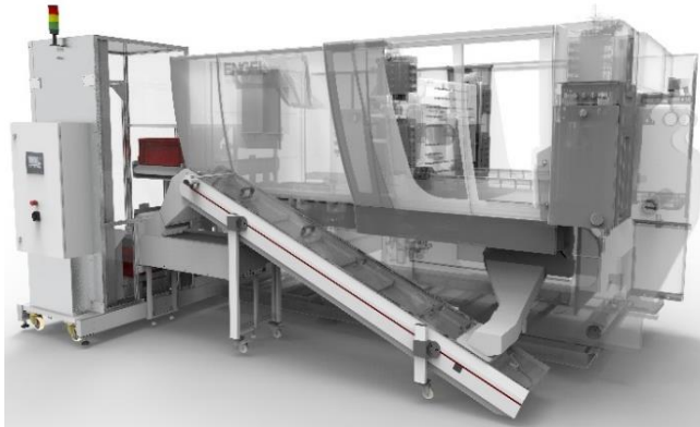
Lift-Pufferanlage im Reinraum
