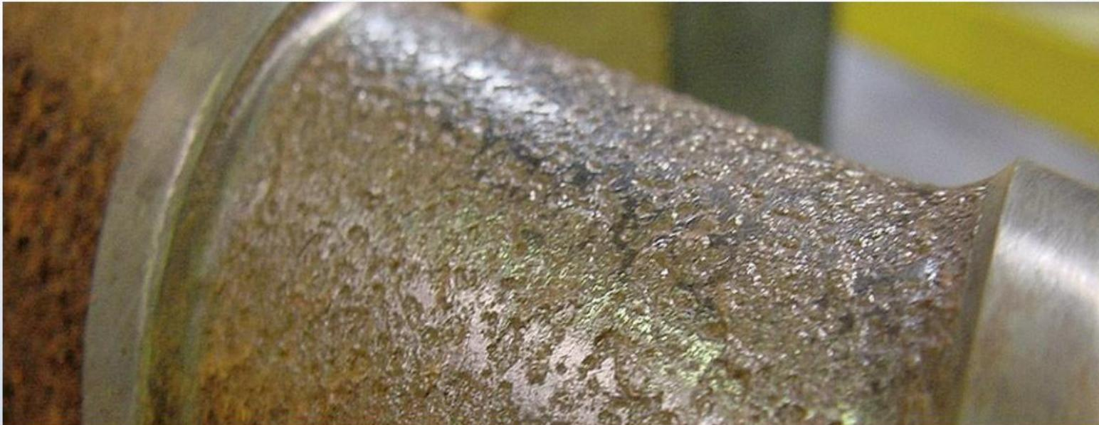
Das Ergebnis von Korrosion aufgrund von Kontakt mit Stabilisatoren, additiven, Flammschutzmitteln, ...
