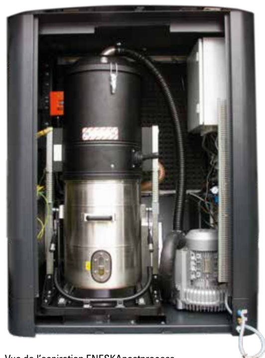
Vue de l'aspiration ENESKApostprocess. Aspirateur entièrement amovible
