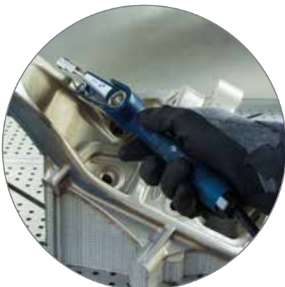
Travail avec une machine de meulage à bande
