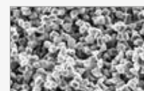
joke Magic grains diamantés de 6 µm – calibrage dense et forme régulière de la grainure –
