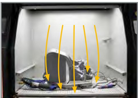
Un guidage de l'air optimisant les flux permet d'orienter les poussières dangereuses vers l'aspiration.
