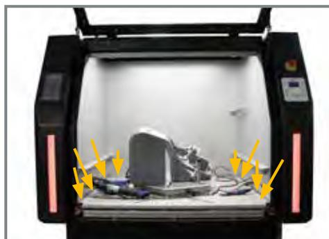
Après l'usinage, l'installation s'ouvre uniquement à l'issue d'un processus de nettoyage automatique spécial, durant lequel les résidus de poussière sont extraits des coins de l'espace de travail par tourbillonnement puis aspirés.
