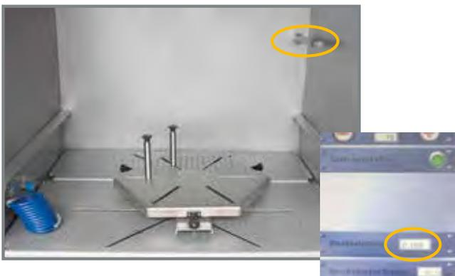
L'installation peut être équipée du dispositif spécial de mesure automatique des poussières fines FSX. La concentration de poussière est mesurée en permanence dans l'espace de travail et s'affiche à l'écran.
