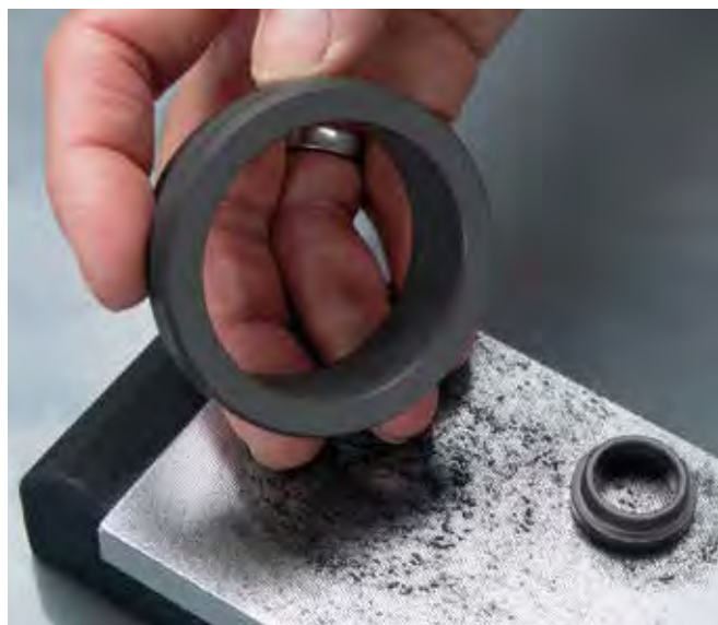
Dressage de joints mécaniques
