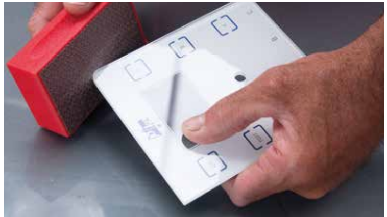
Pour arrondir ou usiner des surfaces en verre
