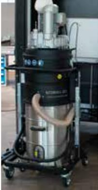
Ihre ENESKApostprocess verfügt über eine interne Absauganlage. Sollten Sie jedoch bswp. **Titan und Aluminium** bearbeiten – also **zwei reaktive Stoffe** – so empfehlen wir mindestens die Verwendung einer zweiten Absaugung. Noch sicherer ist die Verwendung einer zweiten ENESKApostprocess.
