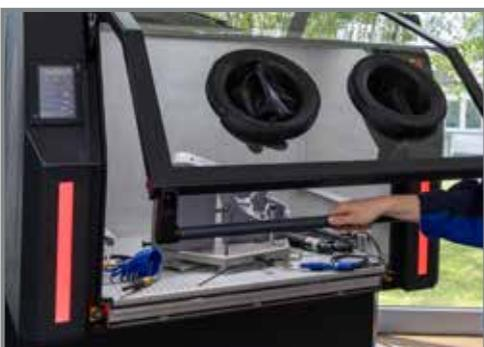
Erst nach erfolgtem Abreinigungsprozess entriegelt die Anlage und der Arbeitsraum wird frei gegeben.
