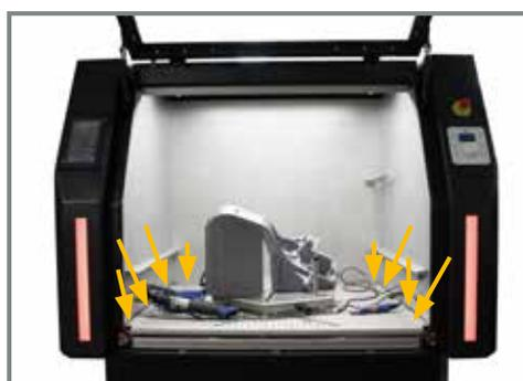
Nach dem Bearbeitungsvorgang lässt sich die Anlage erst nach einem speziellen automatischen Reinigungsprozess öffnen, bei dem Reststäube aus den Ecken des Bauraums aufgewirbelt und abgesaugt werden.
