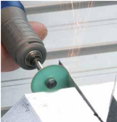
kühler Schnitt mit Keramikfaser-Trennscheibe
