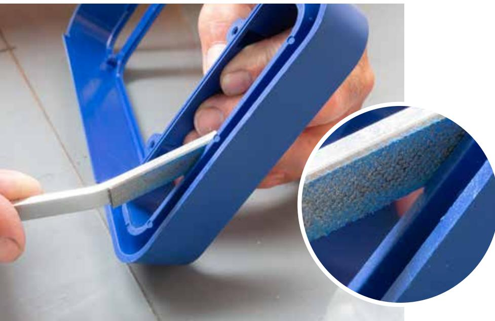
Nacharbeit Hartmetallschneide mit Metallbindung
