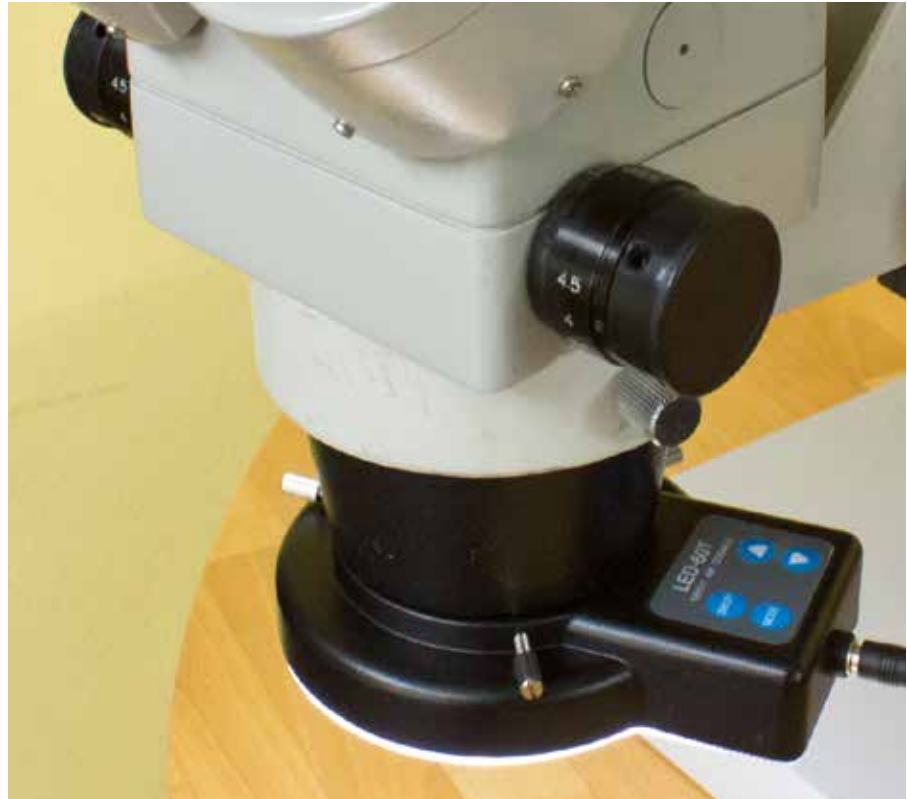
Einsatz der LED-Ringleuchte mit Segmentschaltung am Stereomikroskop SM-200.
