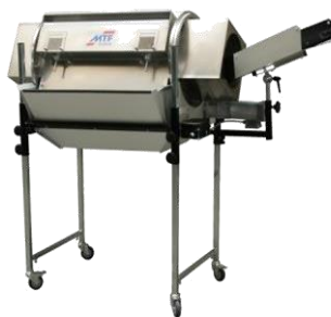
Tambour de séparation rectangulaire pour les plus petites différences de taille
