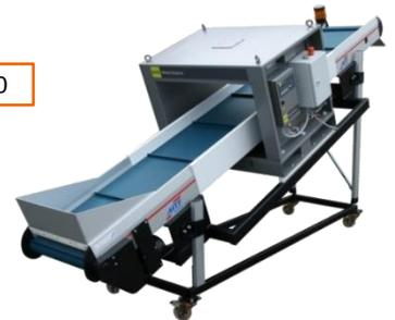
GL-Föba mit Metall-Detektion
