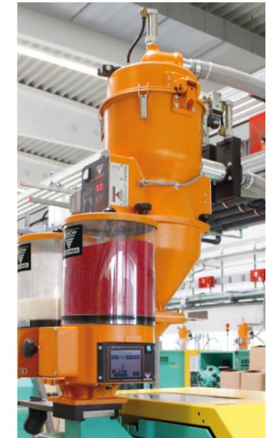
Ideal, wenn neben Masterbatch noch Antistatikum oder Flammenschutzmittel beigegeben werden muss: 2 KEM-TOUCH Dosiergeräte mit Adapterflansch AZ, Materialtrichter Z5 und Förderabscheider TmA8 für zwei Materialien, wie Neuware und Mahlgut.
