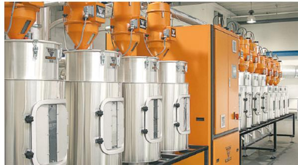
CKT 500 Granulattrockner mit 12 Trocknungsbehälter
