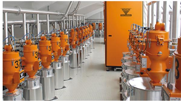
Die zentrale Granulattrockner-Anlage mit insgesamt drei Trockenlufttrockner vom Typ CKT versorgen bei der Procter & Gamble Manufacturing GmbH 38 Trocknungsbehälter mit einer Trockenluftmenge bis zu 1600 m<sup>3</sup>/h
