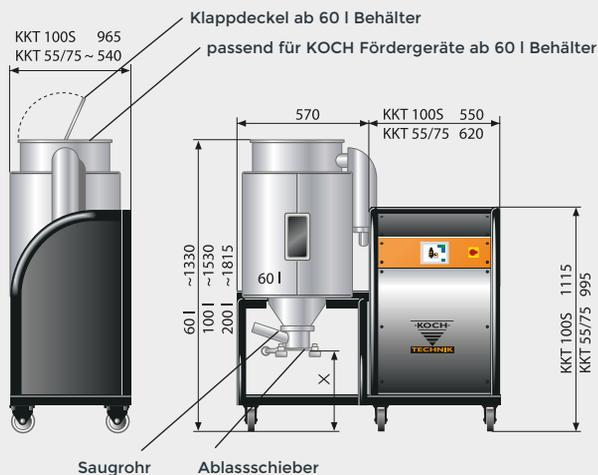
Maß X bei 40 / 60 / 100 / 200 l = 400 mm bei 12 l + 24 l = 530 mm
