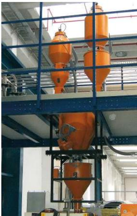
GRAVIKO GK 1000 mit Loss-in-Weight Steuerung in der Anwendung
