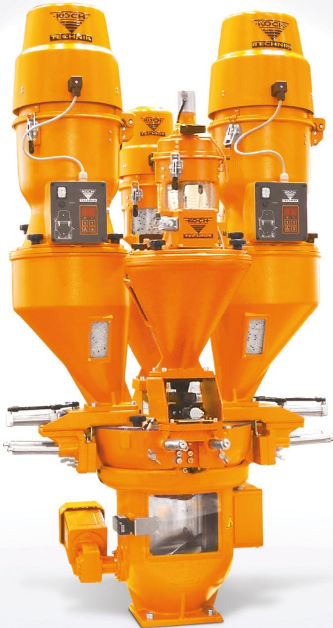
Gravimetrisches Dosier- und Wägesystem für Kunststoffmaterial
