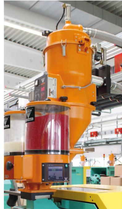
Idéal pour compléter des pré-mélanges ou agents antistatiques éventuellement de retardateurs de flamme : 2 colorateurs KEM-TOUCH montés sur une bride AZ, trémie intermédiaire Z5 et séparateur double-voies TmA8 pour matières vierge et broyé.
