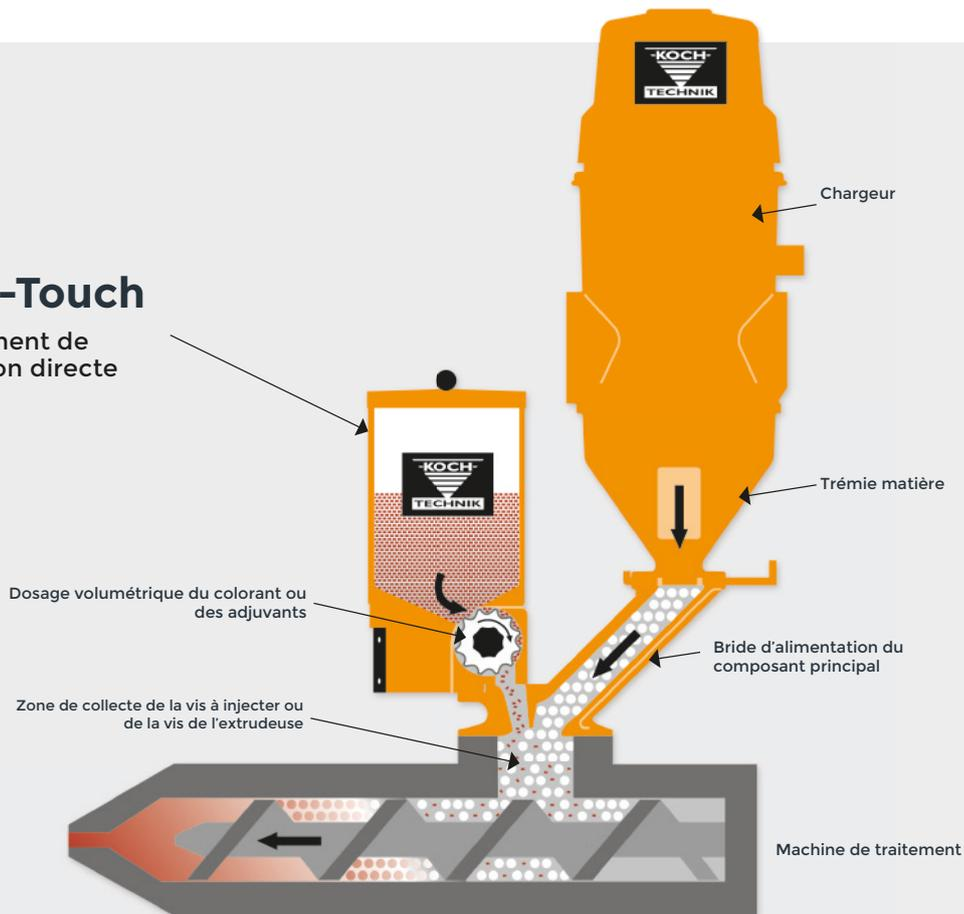
L'équipement de coloration directe KEM-TOUCH présente une solution avantageuse au niveau du prix pour doser des colorants ou adjuvants directement en entrée de la presse à injecter ou de l'extrudeuse. Grâce à une haute précision, l'équipement KEM assure une coloration continue et exacte du produit final. Le dosage volumétrique s'effectue pendant la durée totale du recul de la vis. Le colorant s'écoule directement dans le flux de
