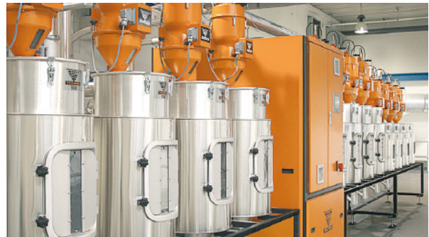
CKT 500 Granulattrockner mit 12 Trocknungsbehälter
