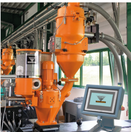
Mélangeur G avec deux stations de dosage Kö et nouvelles unités de commande SLT et MCT avec écran couleur tactile de 7"
