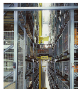
Un entrepôt moderne entièrement automatisé permet un accès rapide aux pièces de rechange et pièces d'usure.
