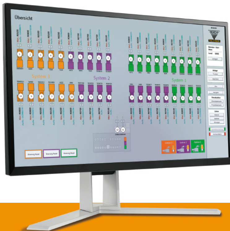
Abbildung zeigt die Steuerung einer Zentralförderanlage (zentrale Materialversorgung)
