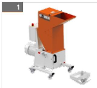
Pour ouvrir le broyeur, commencez par extraire la trémie d'aspiration par l'avant.
