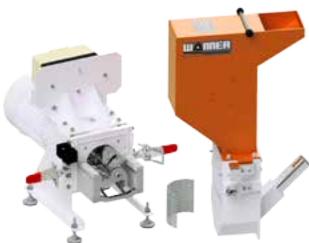
B 08.10 Mühle komplett geöffnet ▲
