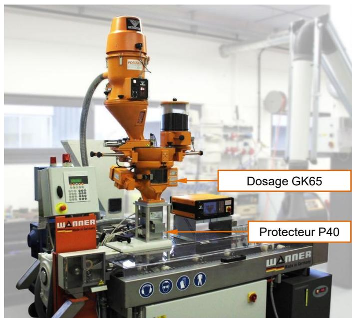
Thermogranulateur comme par exemple pour des applications de compoundage avec dosage gravimétrique GK65 de Koch-Technik et le détecteur de métaux Protecteur P40 de Sesotec
