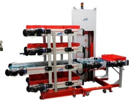
Système de levage électrique
