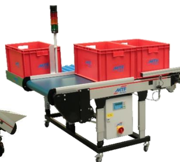
GL-LD 010 mit Querschleibeeinrichtung und Rollenbahn
