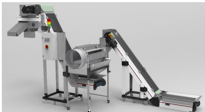
Förder-, Separier- und Verteillösung für empfindliche Kunststoffteile
