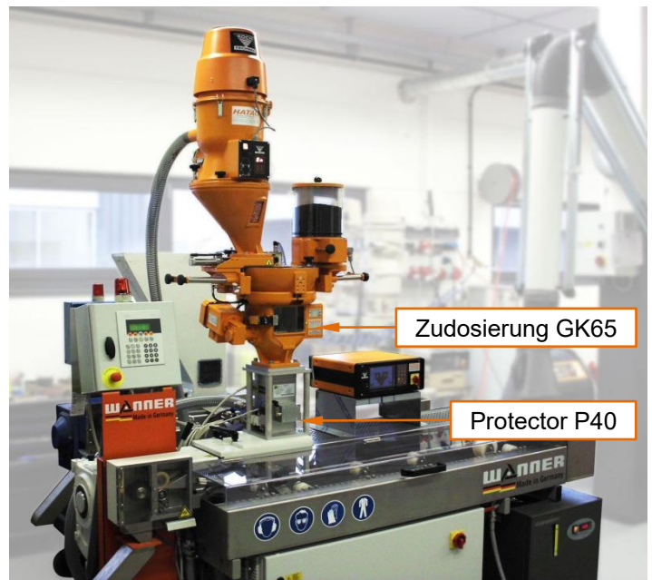
Thermogranulator als Compoundieranlage mit gravimetrischer Zudosierung GK65 von Koch-Technik und Protector P40 Metallsuche von Sesotec
