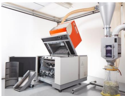
E-Mühle als Zentral-Mühle mit integrierter Material-Abförderung und Entstaubung
