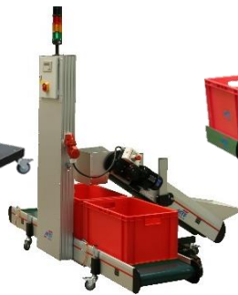
GL-EM 010 als Linearpuffer mit S7 Steuerung
