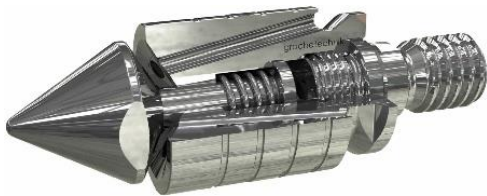
Aktive Rückstromsperre, patentiert Erhältlich ab Ø 40mm Diese speziell konstruierte „aktive“ Rückstromsperre schliesst ohne weitere Schneckenbewegungen nach dem Dosieren. Das Schliessen erfolgt mittels Führungsbolzen, Druckfelder und Dichtkegel ohne Verzögerung nach dem Dosieren.
