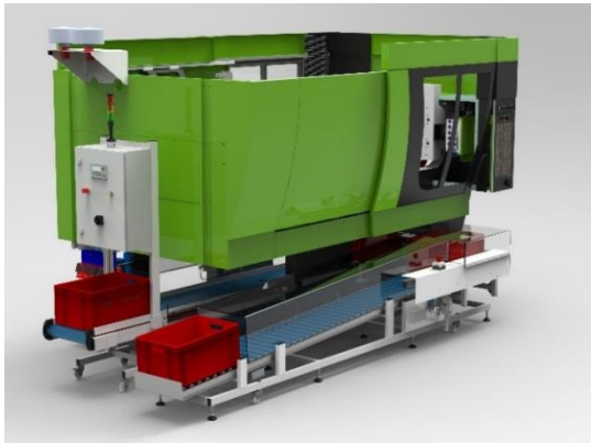
Querschchiebepuffer in Spritzgiessmaschine integriert
