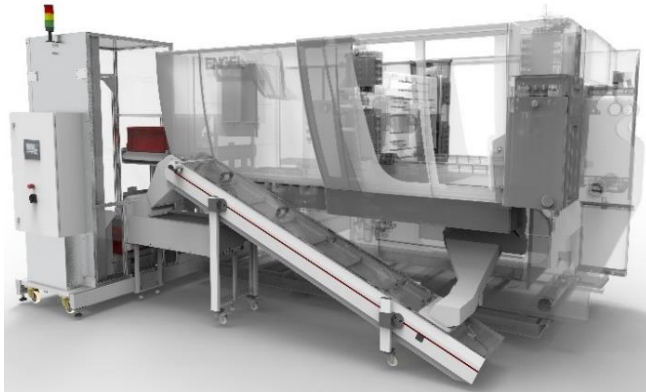
Lift-Pufferanlage im Reinraum
