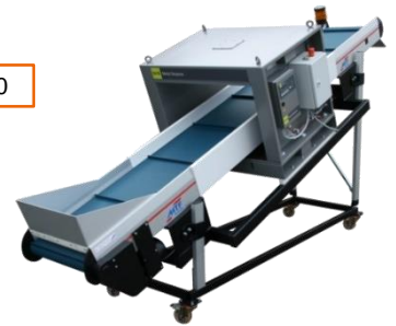
GL-Föba mit Metall-Detektion
