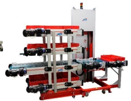
Liftanlage elektrisch 4 Etagen
