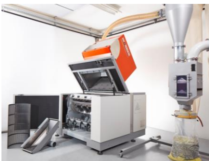
Broyeur E comme broyeur centrale avec dépoussiérage et suppression de matériel intégrés
