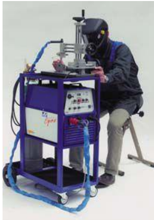
MultiSpot avec fonction d'impulsion unique, pour des soudures très fins.
