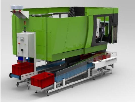
Tampon coulissant croisé intégré à la machine de moulage par injection
