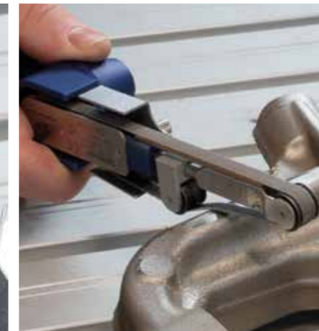
Formes convexes - Machines de meulage à bande et bandes de meulage
