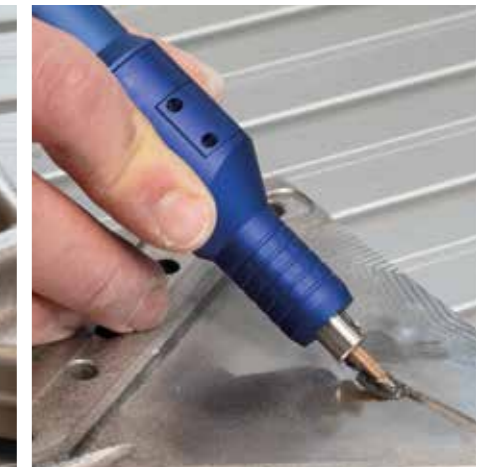
Bois de polissage avec pâte diamantée et machine à limer à main
