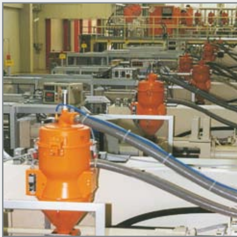
Système d'alimentation avec séparateur A 8 + Z 5
