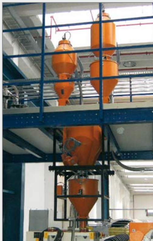
GRAVIKO GK 1000 équipé d'un système de pesée
