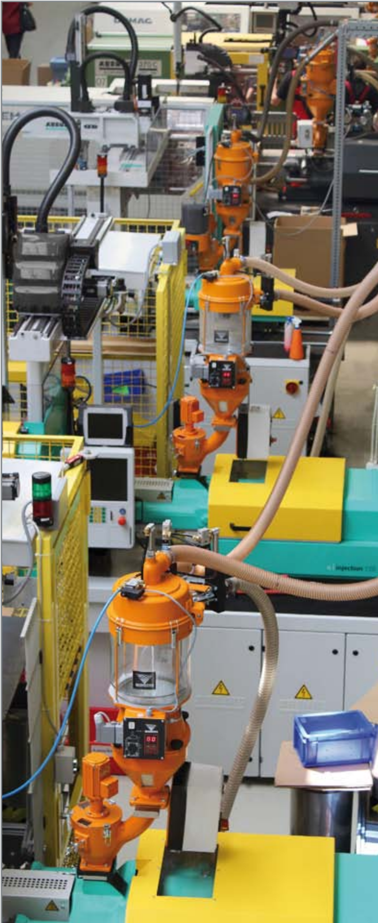
Changement de matière et nettoyage simple: les éléments sur la machine peuvent pivoter ou encore être ouverts, en quelques secondes et sans aucun outil. (Illustration : K-Zeitung)
