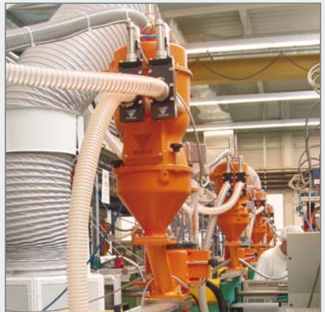
Séparateur Tm A 8 pour l'alimentation en matière vierge et en rebroyé
