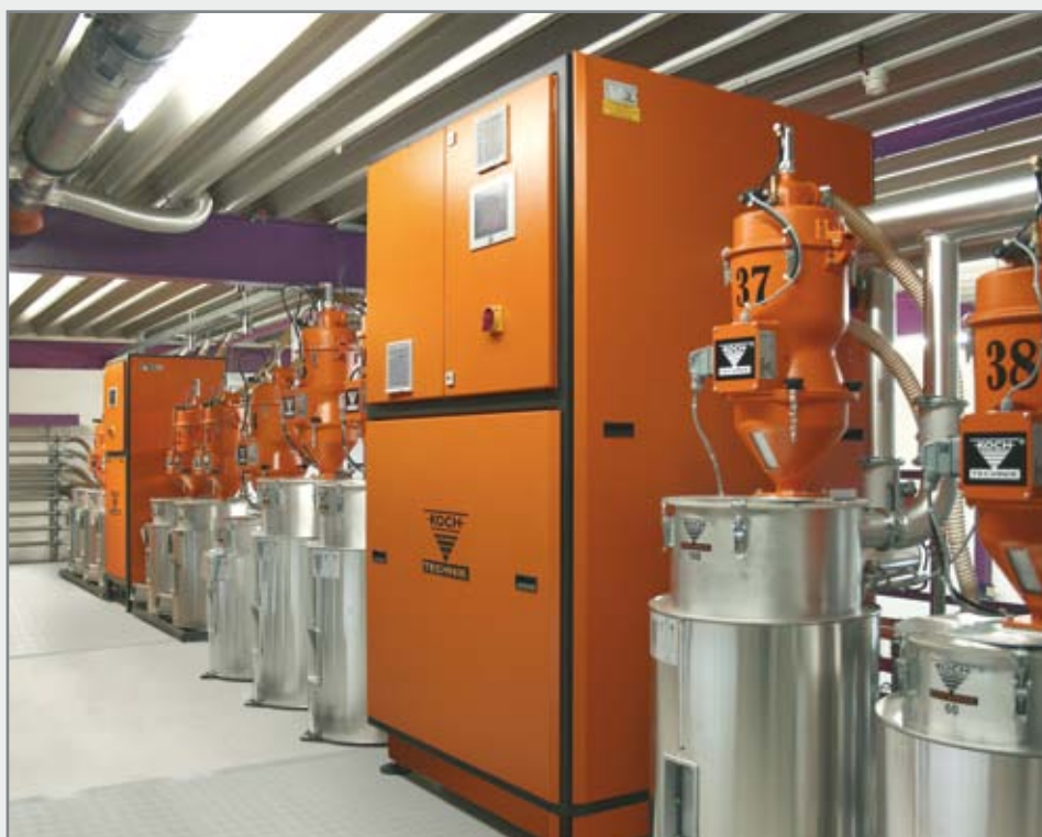
Dessiccateur CKT 500 avec système de contrôle ÖKO
