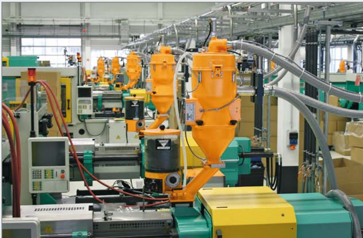
Alimentation centralisée avec colorateur direct KEM / AZ / Z5 + séparateur TmA8.
