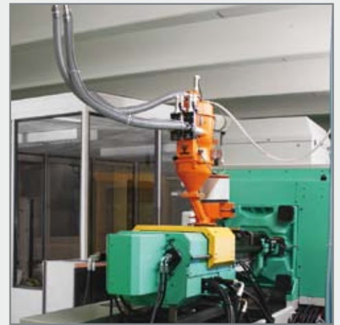
Presse à injecter avec KEM + A 8 en module salle blanche
