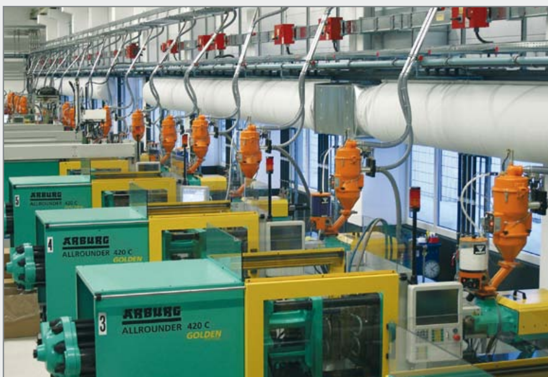
Alimentateurs avec des colorateurs directs dans l'alimentation centralisée d'un fabricant d'emballages.
