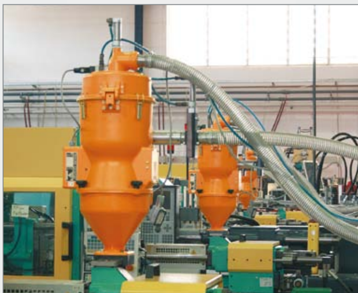
A 8 avec trémie intermédiaire Z 5 et obturateur matière
