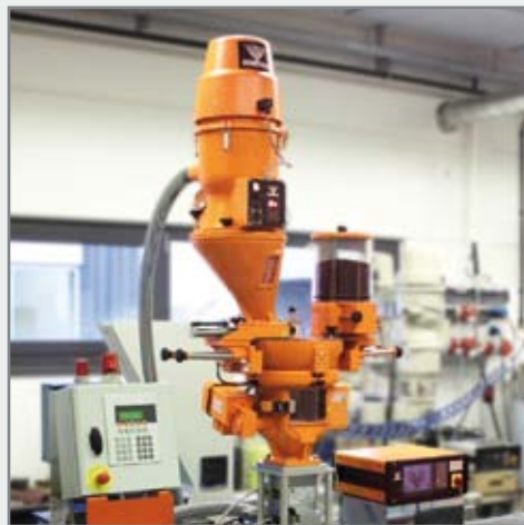
GRAVIKO GK 65 monté sur une extrudeuse pour granulés
