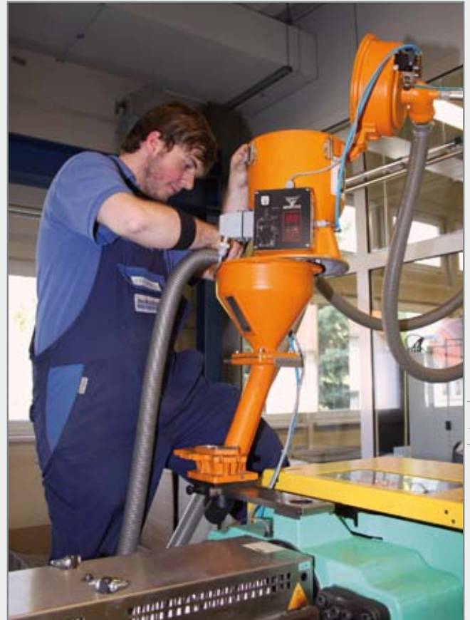
Changement de matière et nettoyage simple: les éléments sur la machine peuvent pivoter ou encore être ouverts, en quelques secondes et sans aucun outil. (Illustration : K-Zeitung)
