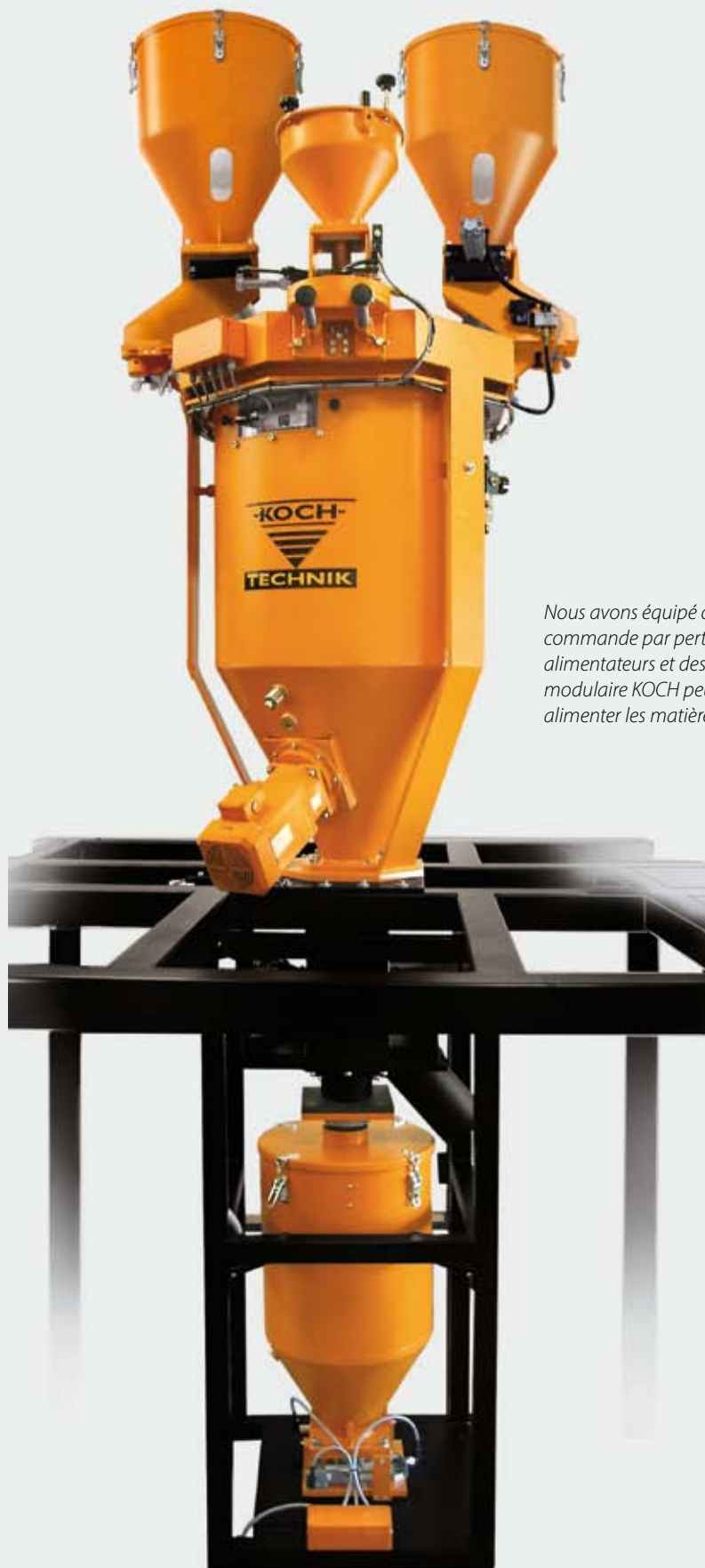
GRAVIKO GK 1000 équipé d'un système de pesée
