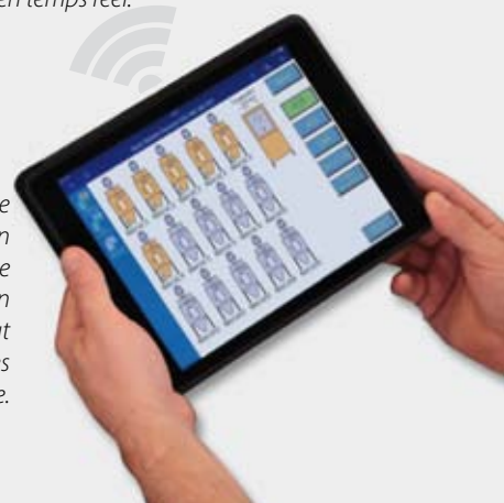
Schéma de fonctionnement sur écran tactile : L'écran affiche à tout moment à quelle étape se situe le séchage de la matière. L'écran tactile vous permet de suivre tous les processus en temps réel.
