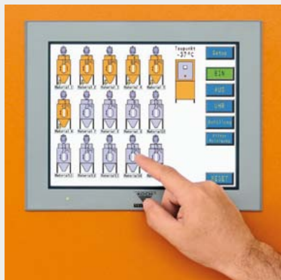
Schéma de fonctionnement sur écran tactile : L'écran affiche à tout moment à quelle étape se situe le séchage de la matière. L'écran tactile vous permet de suivre tous les processus en temps réel.
