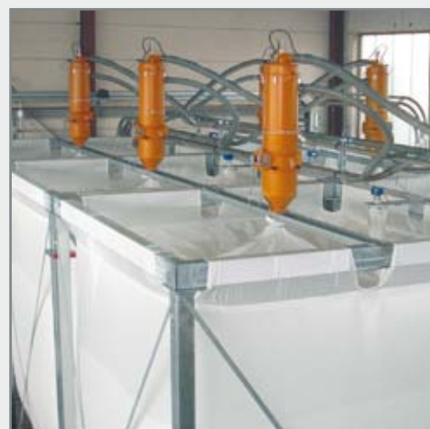
Silos en tissu (conteneurs) en intérieur
