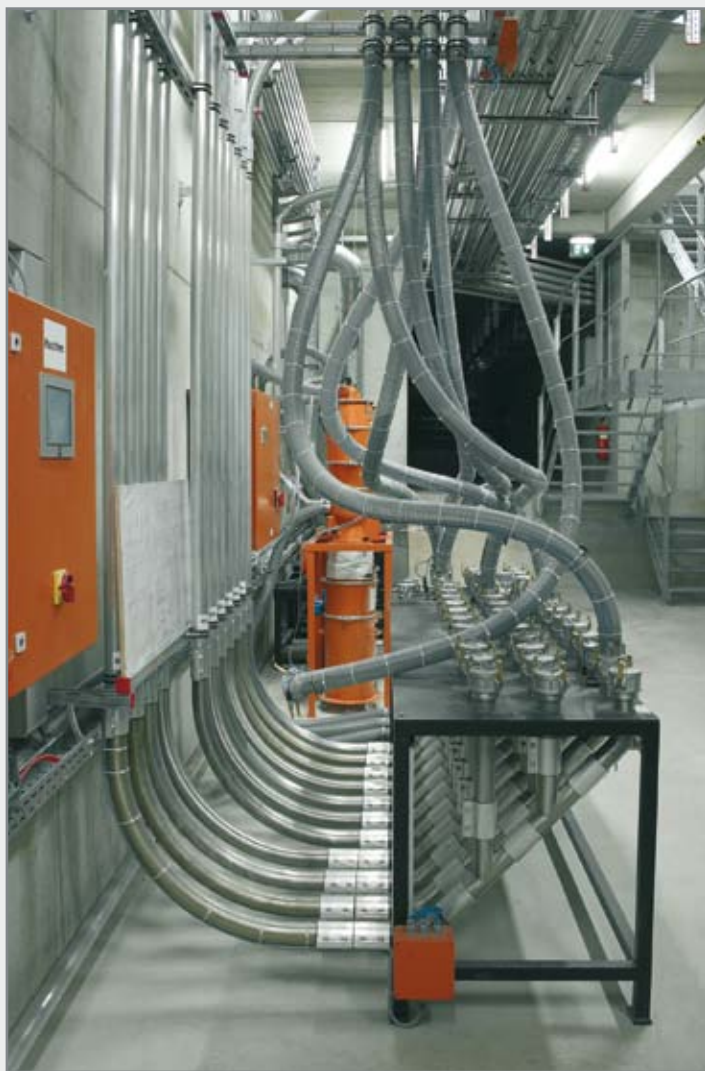
Exemple de station de dérivation
