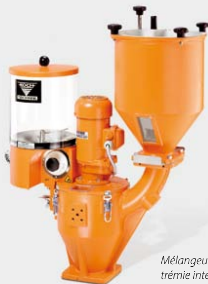
Mélangeur de type KK avec trémie intermédiaire Z 5 et station de dosage Kö 2-1
