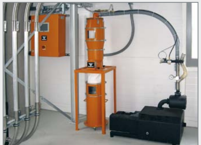
Filtre de sécurité Sa 3 avec armoire de commande SPS (à gauche) et pompe à vide
