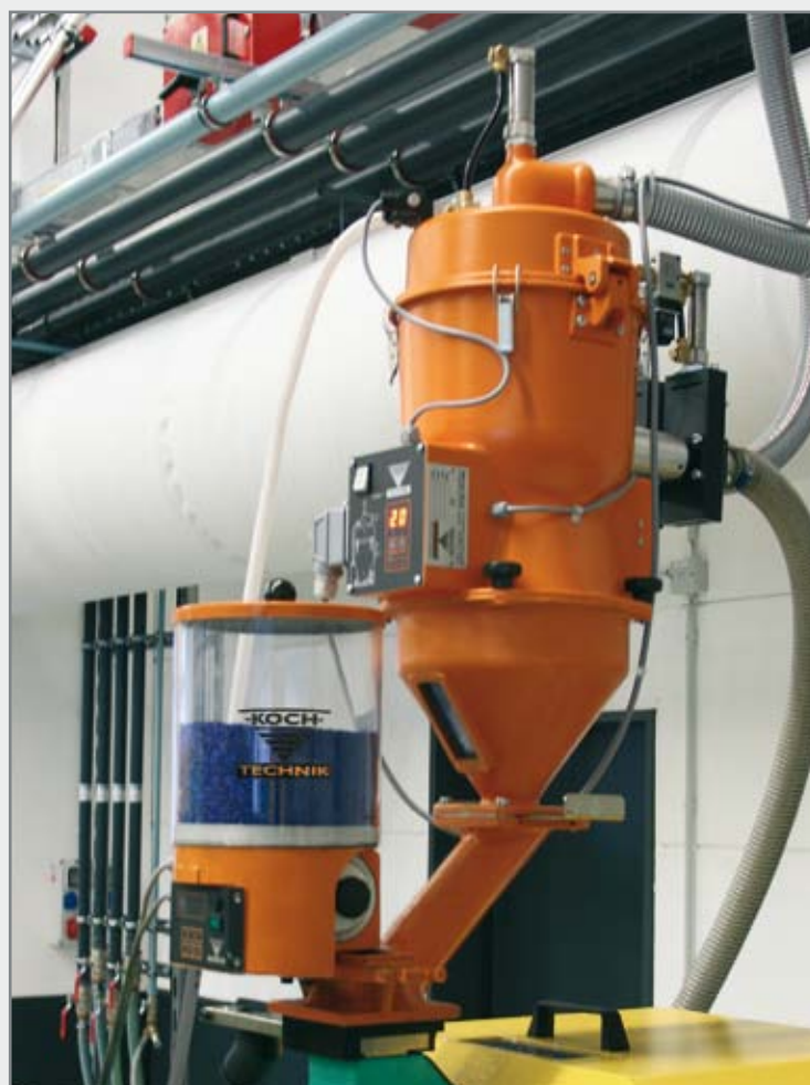
KEM, Tm A 8, Z 5, bride AZ. Colorateur direct avec séparateur double-voie pour matière vierge et broyé dans une alimentation centralisée.
