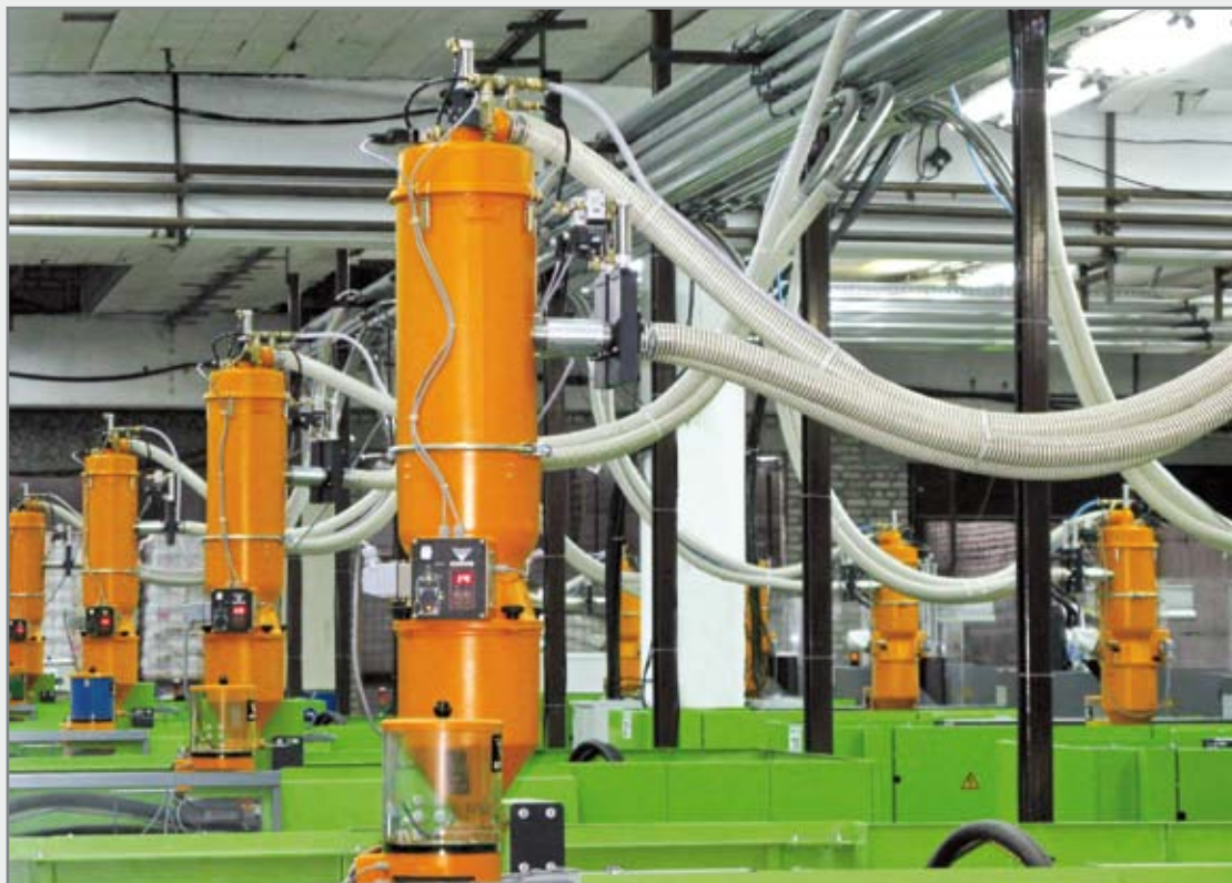
Alimentation centralisée avec colorateur direct KEM / AZ / Z12 + séparateur TmA30
