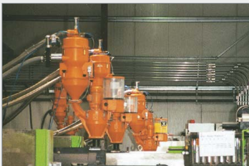
Systèmes d'alimentation avec mélangeurs pour matière vierge ou broyé et masterbatch
