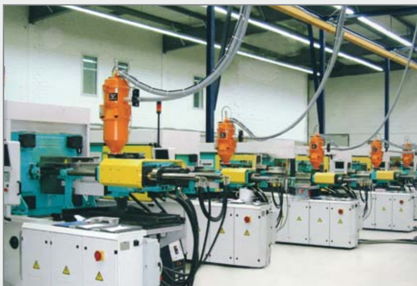
Alimentation centralisée avec séparateurs
