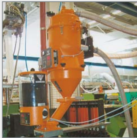
Colorateur direct KEM + A 8 dans une alimentation centralisée
