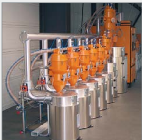
Dessiccateur CKT avec commande d'économie d'énergie ÖKO
