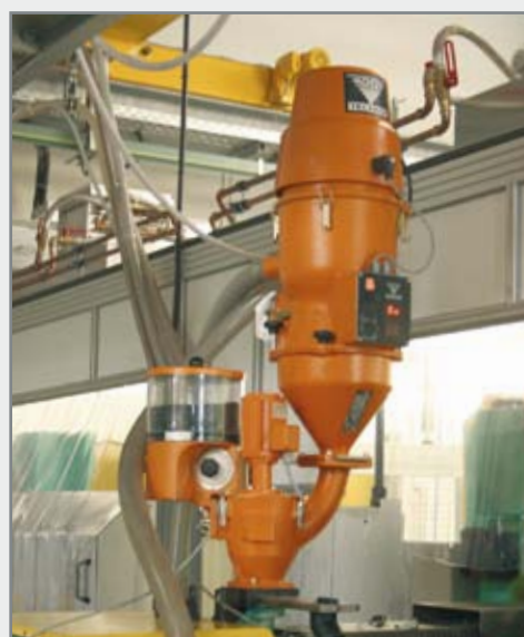
Mélangeur KK avec alimentateur et station de dosage
