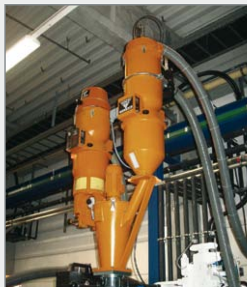
Mélangeur V12 avec station de dosage et alimentateur
