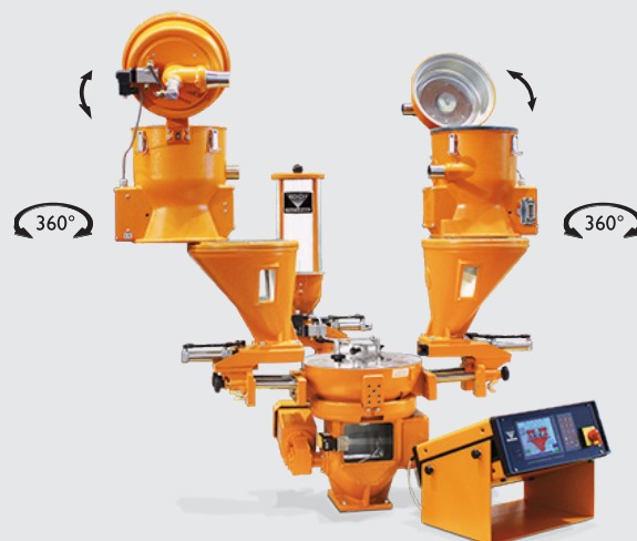
GRAVIKO type GK65, système modulaire avec unité de commande MCM-G Touch. Rotation, bascule et déplacement sont réalisés sans outillage !
