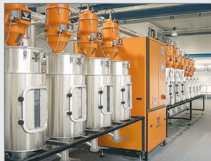
Dessiccateur de granulat CKT 500 avec 12 cuves de séchage
