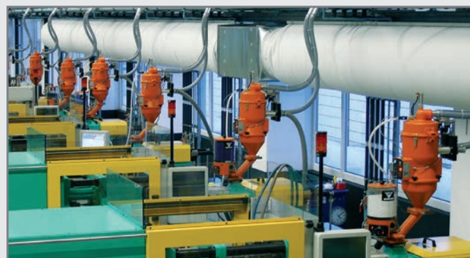
Système central de convoyage en matériaux avec coloration directe - Système exemplaire pour un approvisionnement en matériau flexible avec Industry 4.0
