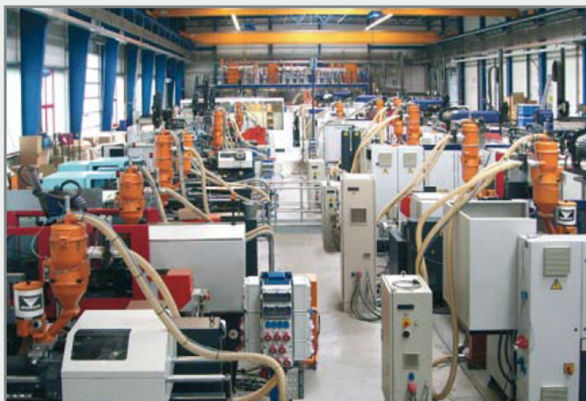
Alimentation centralisée avec séchage central (trois dessiccateurs CKT avec cuves de séchage sont visibles en arrière-plan), appareils de dosage et colorateurs directs
