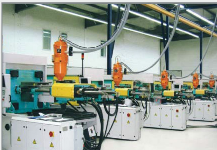
Alimentation centralisée avec séparateurs
