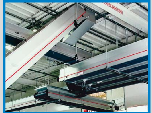
Une automatisation assistée par ordinateur entre la machine de moulage par injection et la presse: les pièces moulées par injection peuvent être distribuées aux autres convoyeurs grâce aux convoyeurs transversaux à réglage pneumatique de MTF Technik.
