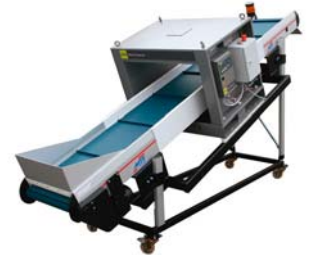
Convoyeur d'alimentation de broyeur avec détecteur de tunnel
