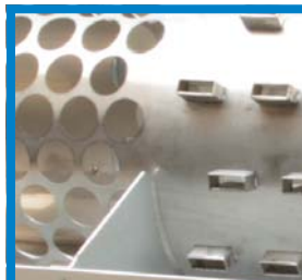
Détails d'une combinaison tambour perforé/tambour de type "hérisson"
