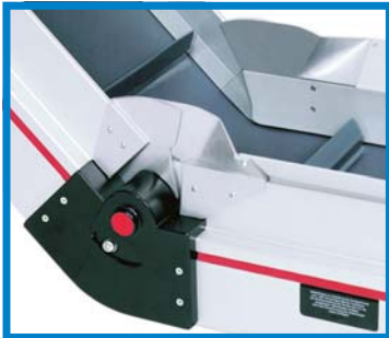
Jonction absolument étanche et sans rebord entre la partie ascendante de la bande et la partie plate – indépendamment de la plage d'inclinaison réglée entre 0° et 60°
