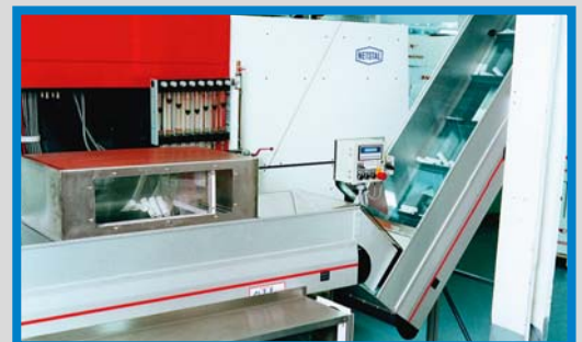
Un système fermé: le transfert de la machine de moulage par injection à l'installation de mécanutention MTF.
