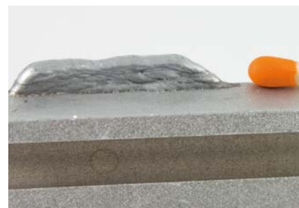
Soudure sur aluminium
