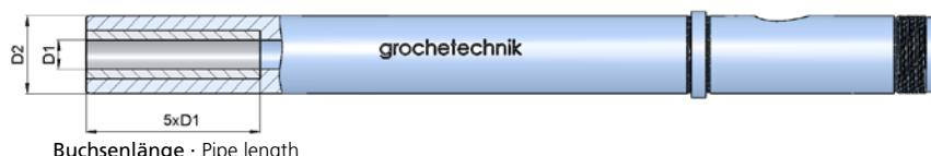
Der Zylinder wird 5 L/D tief ausgedreht, eine Buchse mit Original-Durchmesser wird eingeschrumpft. Die Bohrung wird von hinten gehont, um einen möglichst sauberen Bohrungsübergang herzustellen.
