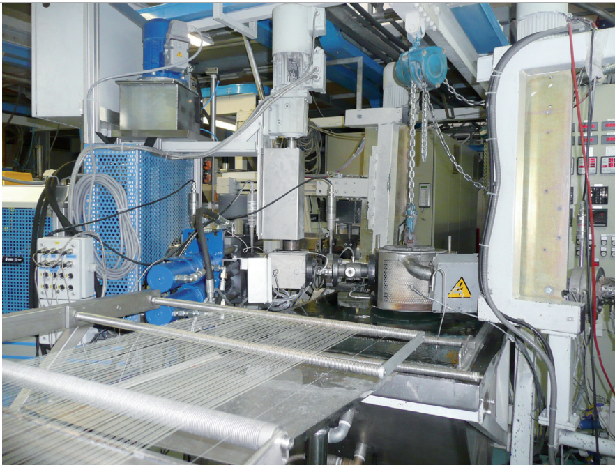
Die Extrusion von Hightech-Filamenten in unterschiedlichen Farben und Qualitäten stellt hohe Anforderungen an die Reinigung der Schnecken und Werkzeuge. Effizienz ist hier von hohem wirtschaftlichen Wert.
