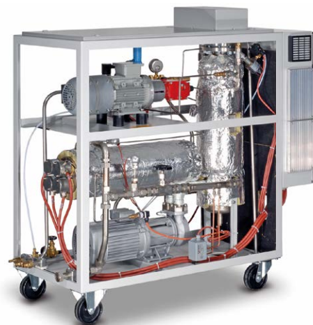
Prüfstands-Wassertemperiersystem für bis zu 200\text{ °C} mit einer Heizleistung von 48\text{ kW} und vielen Sonderfunktionen zur Versorgung einer dampfbetriebenen Kolbenmaschine; Regelung von Systemdruck und Temperatur inklusive frequenzgeregelter Nachspeisung
