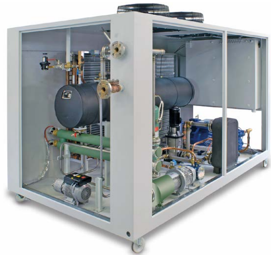
Kombiniertes Heiz-Kühl-Aggregat mit Kompressorkreislauf zur autarken Kühlung und maximaler Druckwassertemperatur von 160\text{ °C}
