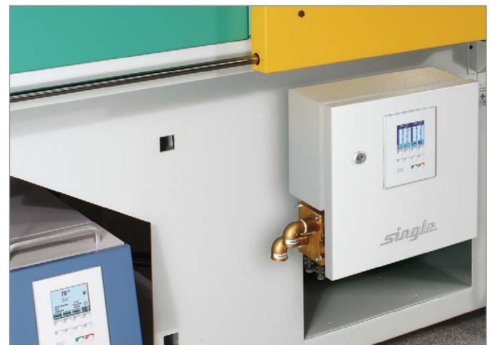
Wasserverteilsystem SWV zur Durchflussmessung an einer Spritzgießmaschine
