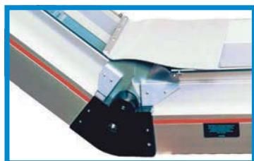
Flexible Abdeckung der verstellbaren Winkel, z.B. für Reinraumanwendungen
