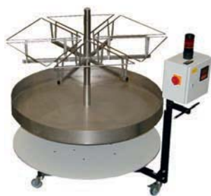
Aufnahmeanlage mit Edelstahlwanne für den Reinraum
