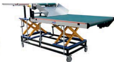
Höhenanpassung mittels Scherenhubtischen
