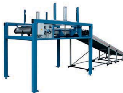
Bandkombination mit pneumatischer Abkippvorrichtung zur Großbehälter- befüllung
