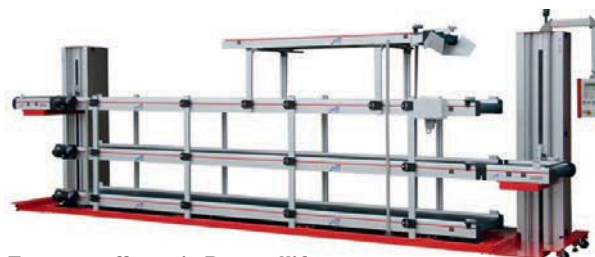
Etagenpuffer mit Doppellift und Roboter-Ablageband
