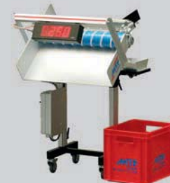
mit Teilevereinzeler und Zählwerk
