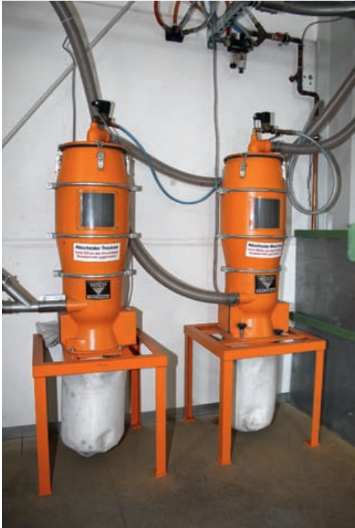
Zwei Zentralfilter filtern Verunreinigungen und Staubpartikel bis zu 2\mu aus der Förderluft
