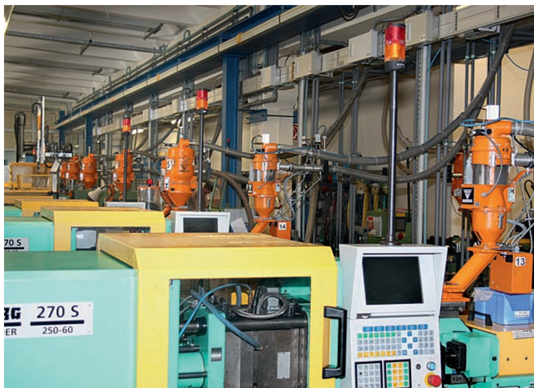
Bei Nokutec ist heute jede Maschine mit Zwei-Komponenten Förderabscheider und Mischweiche ausgestattet
