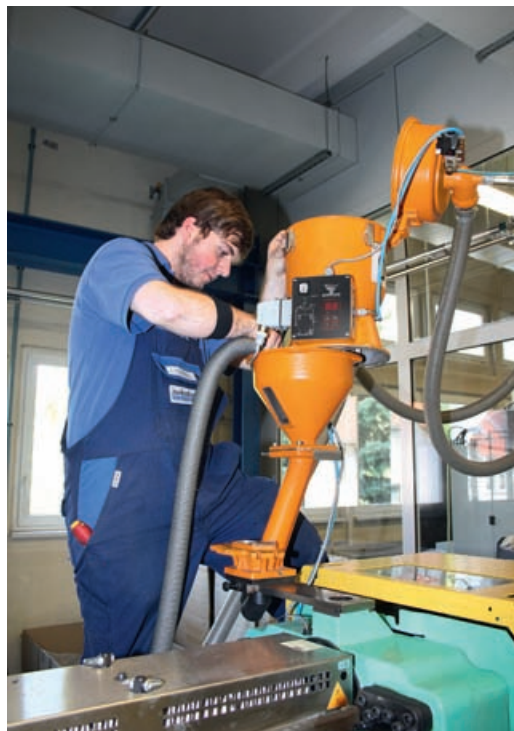
Das Fördergerät ist ohne Werkzeug aufklappbar, schwenkbar und leicht zugänglich: Toni Pilkenroth als Bediener der Trocknungsanlage reinigt einen Förderabscheider
