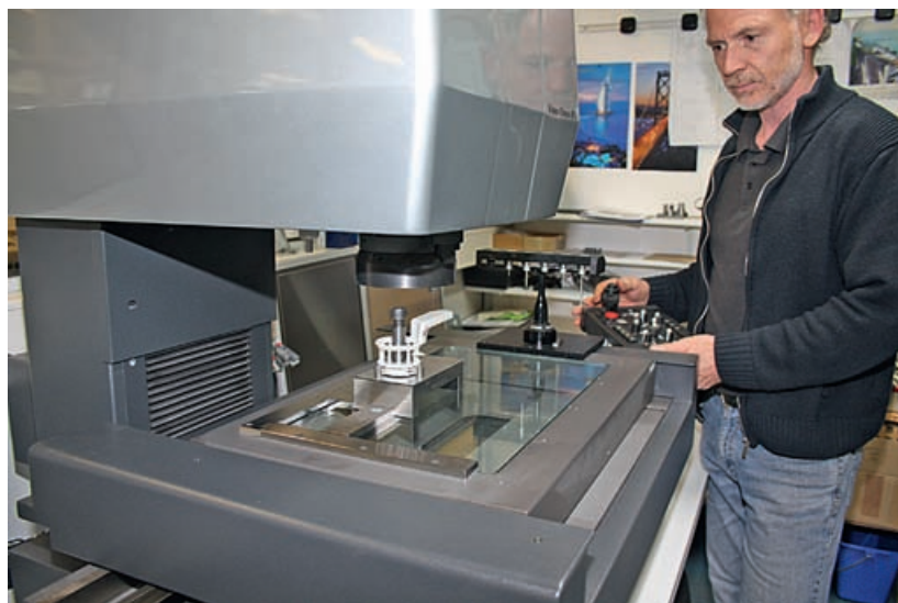
Turnusmäßige Kontrolle: Klaus Dathe aus der Qualitätssicherung nimmt die exakten Maße eines Formteils mit Taster ab
