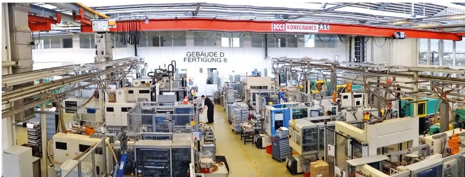
200 Spritzgießmaschinen werden bei Oechsler in Ansbach zuverlässig über Zentralförderanlagen und Trocknungstechnik von Koch mit Material beschickt. Zu gravierenden Ausfällen ist es dabei noch nicht gekommen
