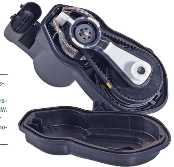
Einer der Hauptwachstumstreiber für Oechsler 2012: Der Aktuator für die elektronische Parkbremse von TRW. Sie wird derzeit von elf der 15 weltweit größten Automobilhersteller eingesetzt
