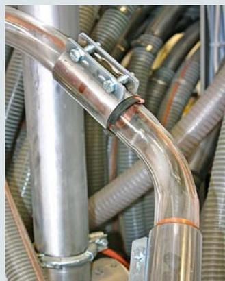
Das komplexe Fördersystem einer Materialversorgungsanlage besteht aus der Saugleitung für den zur Förderung benötigten Unterdruck und aus den Materialleitungen. Förderleitung und Materialleitung bestehen aus V2A-Edelstahlrohren. Die Umlenkungen in den Materialleitungen sind bei Oechsler mit 5 mm dicken speziellen Glasbögen ausgelegt, um dem glasfaserhaltigen Material die geringste Aufprallfläche zu bieten und Verschleiß auszuschließen
