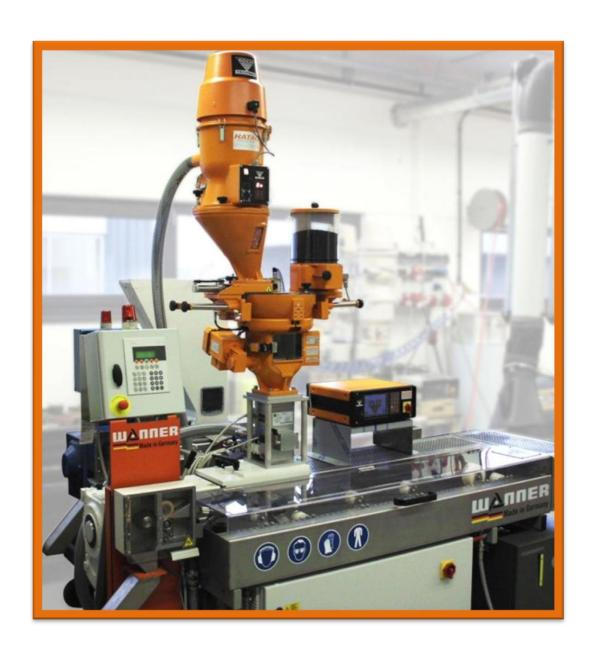
Mahlgut, Restmaterial und Masterbatch werden über einen GK 65 von Koch-Technik, durch den S+S Protector (Metallsuchergerät) dem Wanner-Thermogranulator gravimetrisch zudosiert. Im Verarbeitungsverlauf des Granulators wird das Material anschließend extrudiert, gekühlt in einem Abkühlbad und geschnitten. So entsteht wieder hochwertiges Kunststoffgranulat.
