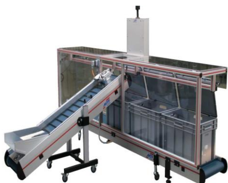
Linear-Pufferanlage mit Zuführband
